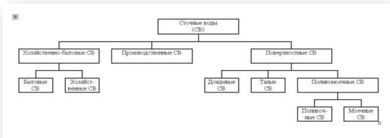
**ж) оценка воздействия сбросов сточных вод через централизованную и децентрализованную систему водоотведения на окружающую среду**
